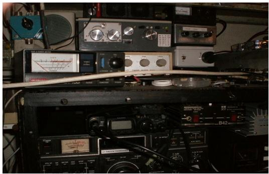
A nulla valgono i vari ausili adottati in bassa frequenza, inseriti dopo l'uscita del segnale audio del ricevitore (leggi Filtro DATONG visibile dietro il ROSmetro che riduce la banda passante audio a 300 Hz) in quanto il "danno" lo crea il ricevitore che si desensibilizza in presenza di segnali forti adiacenti.
